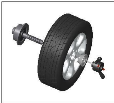
Peavõll - ratas - sobiv koonus (väike ots siseküljel) - kiirkinnitusmutter
